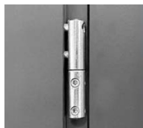
Otočné panty Ø20, nastavitelné 3D, šroubované, v barvě zinek bílý, k montáži na protipožární dveře. SILENZIO HAL 32, SILENZIO HAL 32 a SILENZIO 46/43/42 ve standardní výbavě
